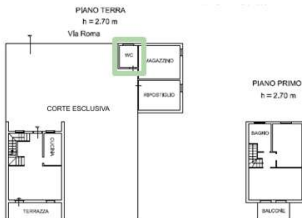
Esempio di locale accessorio a servizio diretto di locali indiretti non comunicanti (poligono tipo C)
