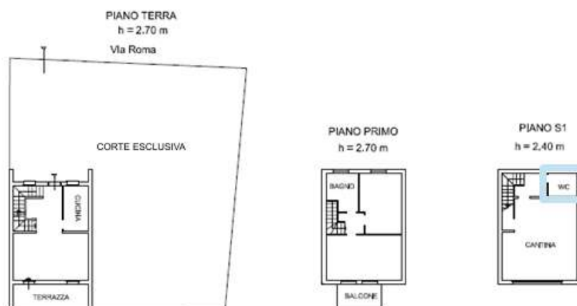
Esempio di locale accessorio a servizio diretto di locali indiretti comunicanti (poligono tipo B)
